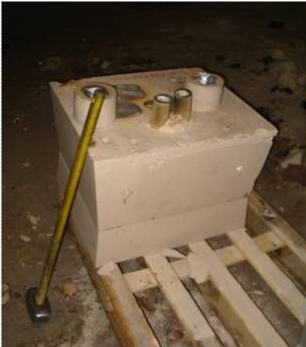
Casse des moules : manchons friables
